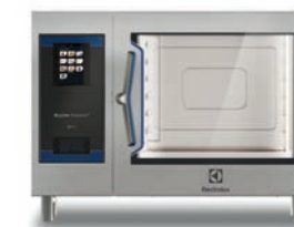
6GN 2/1 Außenmaße (B x T x H) 1.090 x 971 x 808 mm Elektrische Leistung - 21,4 kW Gasleistung - 32 kW
